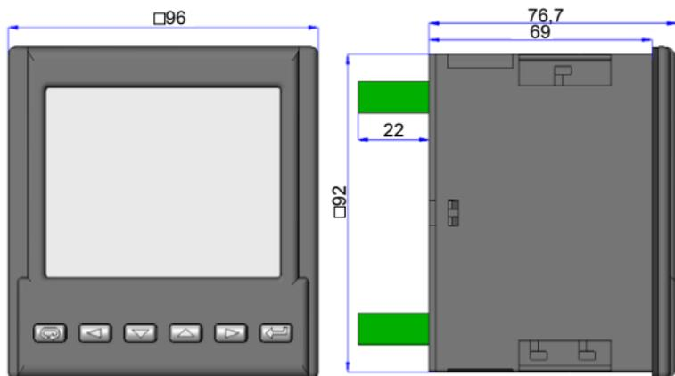
**Fig. 2. Meter dimensions.**
