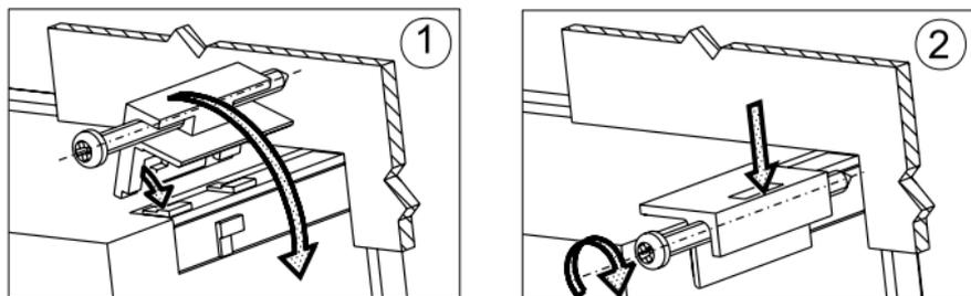
**Fig. 1. Meter fitting.**
